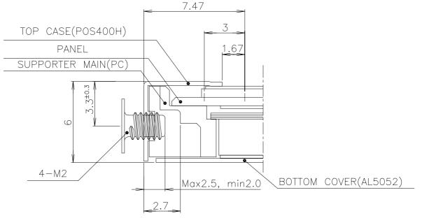
\*MOUNTING SCREW DEPTH : MAX 2.5mm \*SCREW(4EA) TORQUE : Max 2.0kgf.cm
